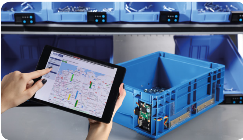
Das Forschungsprojekt DProdLog beschäftigt sich mit intelligenten Behältern, Containern und – wie im Bild – Kleinladungsträgern. Die smarten Behälter kommunizieren selbstständig mit einer Serviceplattform.
